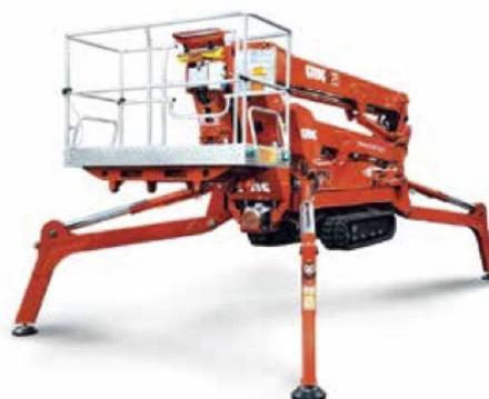
Piattaforma cingolata con due bracci telescopici articolati più Jib e cesta da 1,70 m di lunghezza. Una piattaforma compatta e versatile, dalle incredibili caratteristiche (6,8 metri in negativo). Forte di quattro aree di stabilizzazione e della continua ricerca tecnologica CMC, è assoluto leader di mercato nella sua categoria. 230 kg la portata massima in cesta.
