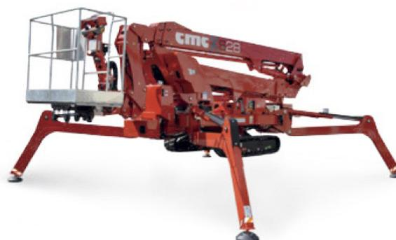
Piattaforma con due bracci telescopici articolati più jib. Un concentrato di potenza e tecnologia pronto a stupire. Con quattro aree di stabilizzazione, due aree di lavoro e stabilizzatori a "scavalco" è in grado di lavorare su ogni terreno e di raggiungere anche i punti più difficili. Ventotto metri di altezza massima di lavoro, 14 di sbraccio e 6,7 in negativo ne fanno una piattaforma senza pari.
